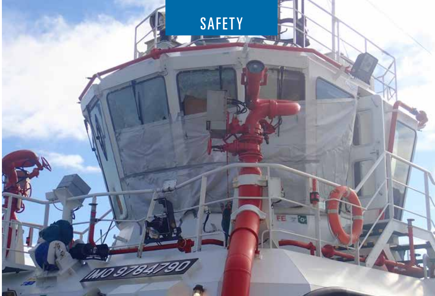
Tug Ibaizábel Doce with broken windows covered by plastic (courtesy Comisión Permanente de Investigación de Accidentes e Incidentes Marítimos, Madrid).
